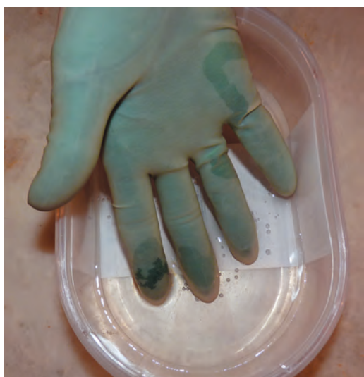
Fot. 2.11. Rękawiczki uwidaczniające miejsce zakłucia przy pracy w mokrym środowisku
