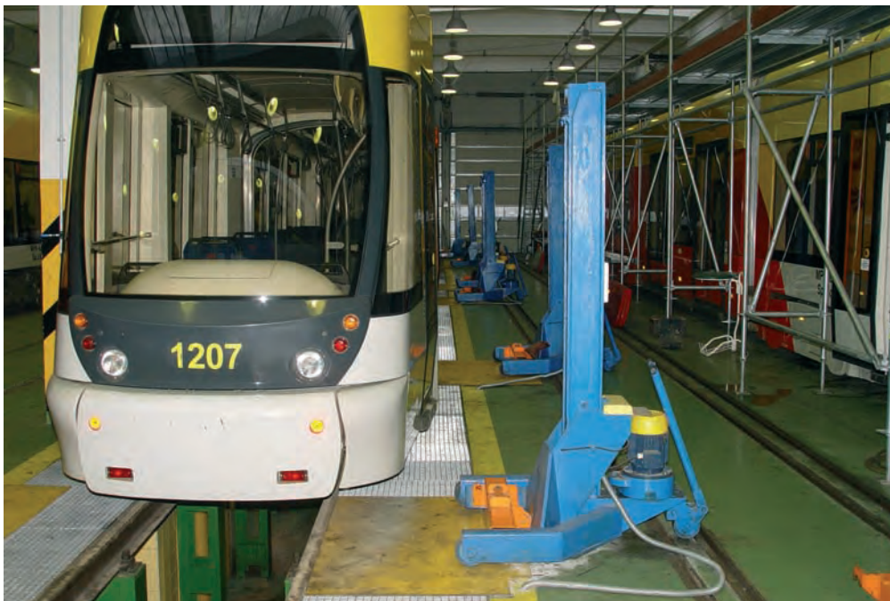
Fot. 5.6. Mechaniczne podnośniki umożliwiające podnoszenie całego składu tramwaju
