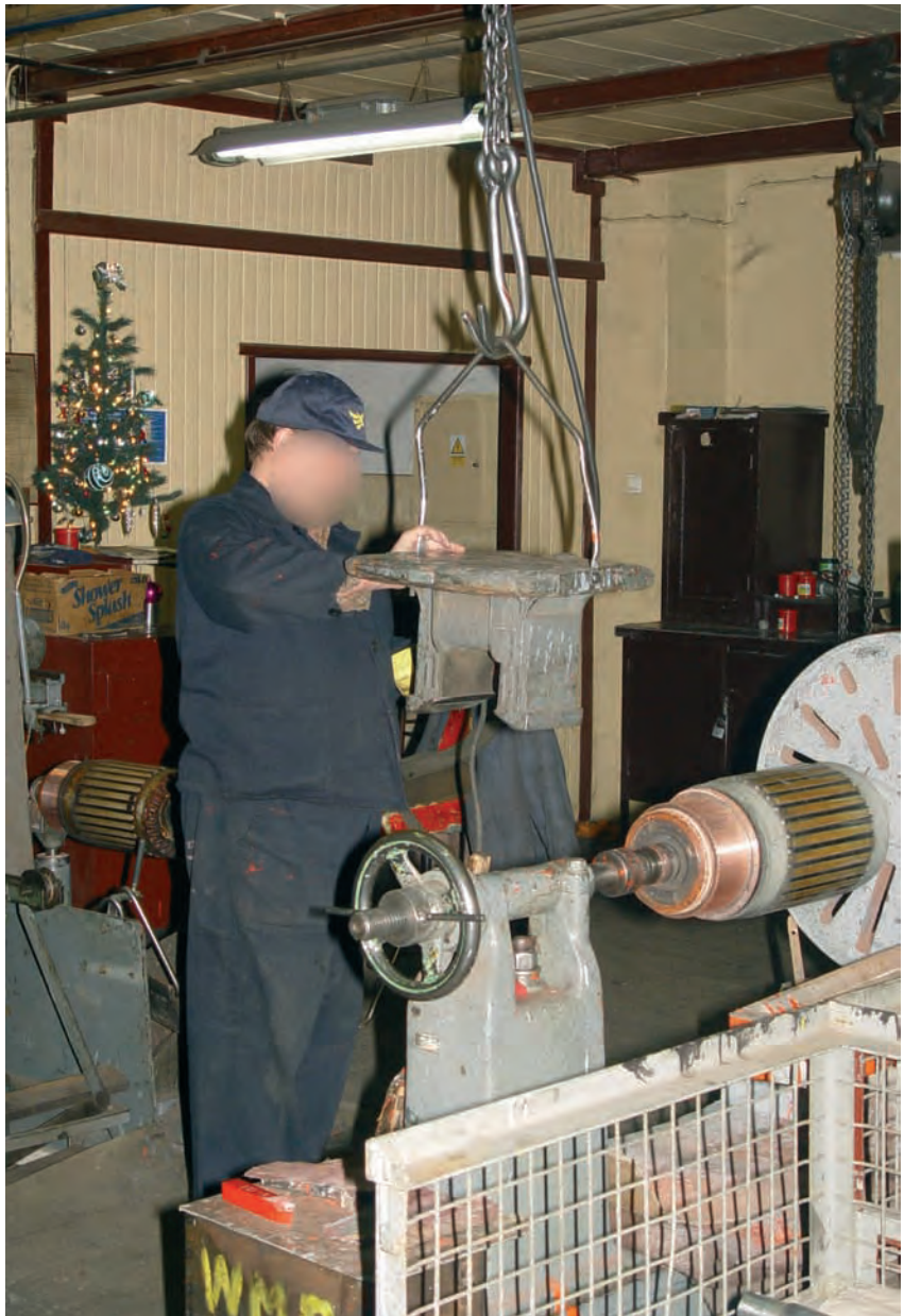
Fot. 5.4. Wykorzystywanie urządzeń mechanicznych eliminujących konieczność ręcznego dźwigania
