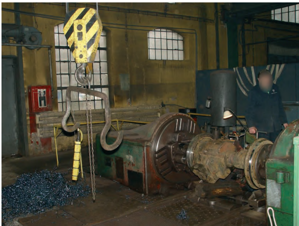
Fot. 5.5. Wykorzystanie haka własnej produkcji, ułatwiającego transport osi tramwaju
