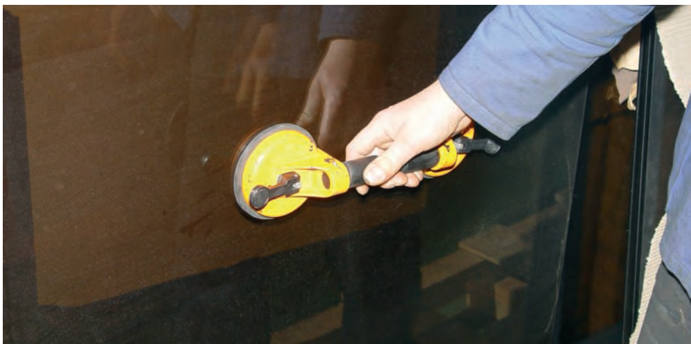
Fot. 5.7. Chwytnik podciśnieniowy ułatwiający ręczne przemieszczanie szyb
