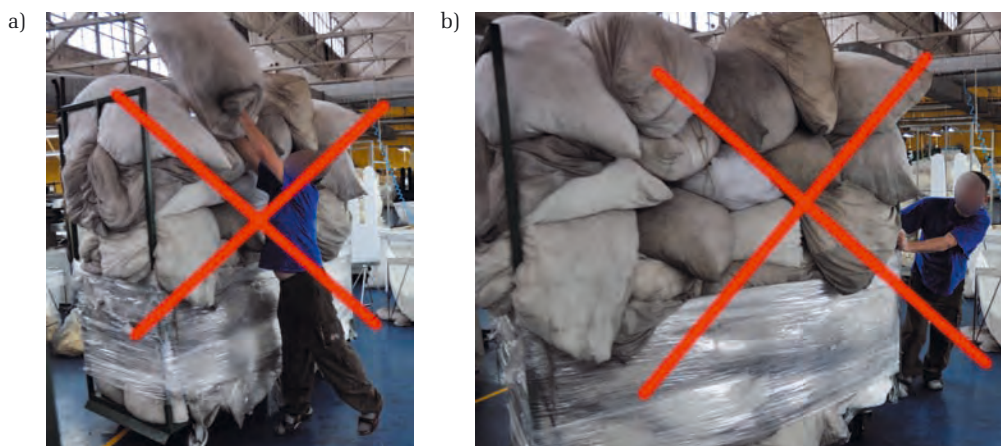
Fot. 10.19. Nie należy przeładowywać wózków transportowych – poza koniecznością przyjmowania przez pracownika niewygodnych i niebezpiecznych pozycji ciała przeładowany wózek utrudnia obserwację drogi
