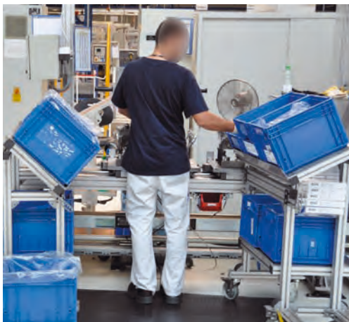
Fot. 7.5. Prawidłowo zorganizowane stanowisko pracy – wszystkie przedmioty, po które należy sięgać, znajdują się w bliskim zasięgu, a pojemniki z częściami są ustawione na odpowiedniej wysokości i pochylone w kierunku pracownika
