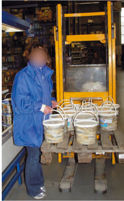
Fot. 7.2. Dobry wózek do transportu palet umożliwia podnoszenie palety, co eliminuje konieczność pochylania się przy przekładaniu towaru na półki
