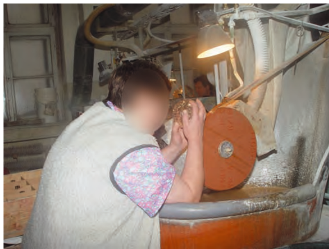
Fot. 7.11. Prawidłowe stanowisko pracy szlifierza kryształów – na krawędzi stołu znajduje się miękka podkładka, na której pracownica opiera ramiona
