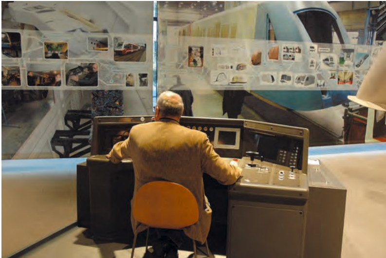
Fot. 7.3. Półkolisty kształt stanowiska pracy (pulpitu sterowniczego) umożliwia łatwe sięganie do wszystkich urządzeń, nawet tych, które są położone na skraju stanowiska
