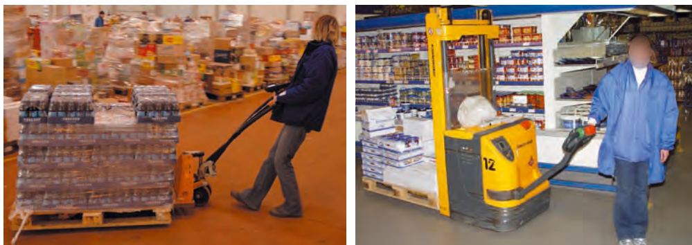
Fot. 7.1. Realizacja zasady używania nadmiernej siły w pracach transportowych; zamiast zwykłego wózka do transportu palet (po lewej) zastosowano wózek z napędem elektrycznym (po prawej)
